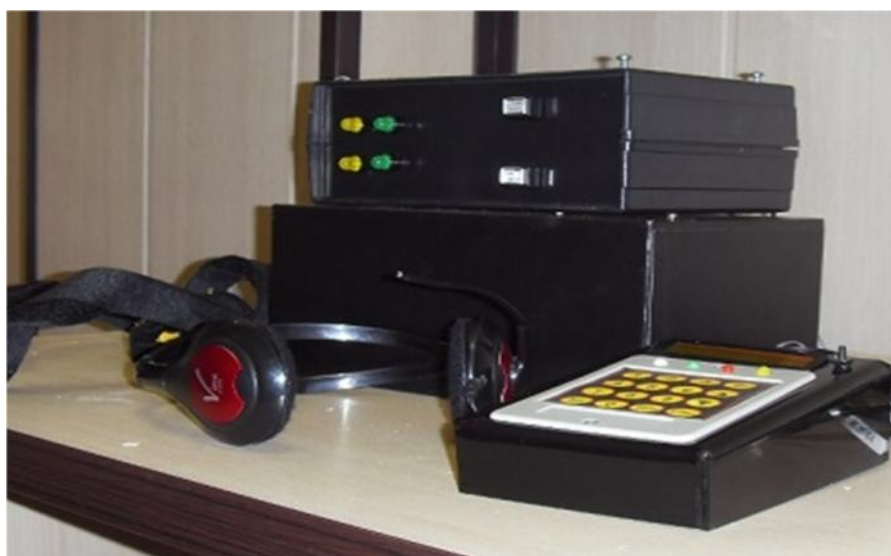
شکل ۱- دستگاه محقق ساخته بیوفیدبک (تنفسی) خانگی
