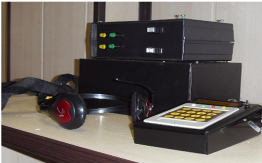
شکل ۱- دستگاه محقق ساخته بیوفیدبک (تنفسی) خانگی
